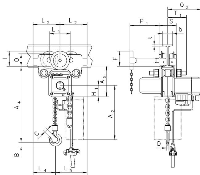
CPA Festverbinding mit Haspelfahrwerk
