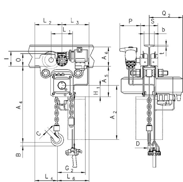
CPA Festverbinding mit Druckluftfahrwerk
