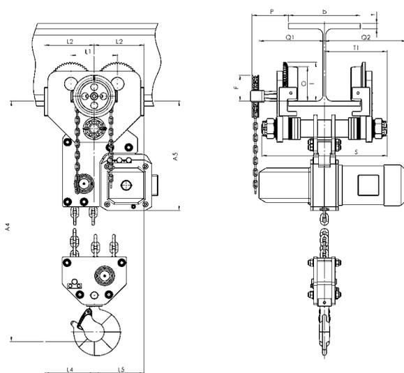
CPE1/CPEF Festverbindung mit Haspel- oder Elektrofahrwerk, 7.500 kg
