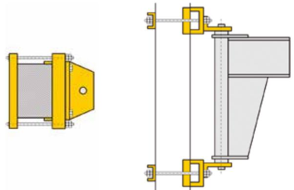
Stützenumklammerung mit Anker und Umfassungskonsolle (Stützenbreite max. 500 mm, Anker bis max. 1.000 mm)
