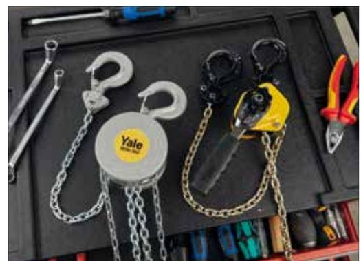
Aufgrund seiner Größe passt der Yale **MINI 360** in jeden Werkzeugkasten und unterstützt den Bediener bei seinen Arbeiten.
