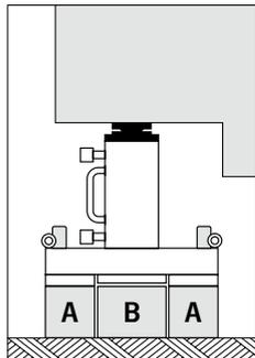
5. Stufe: Breiten Mittelklotz Typ „B“ eingeschoben.
