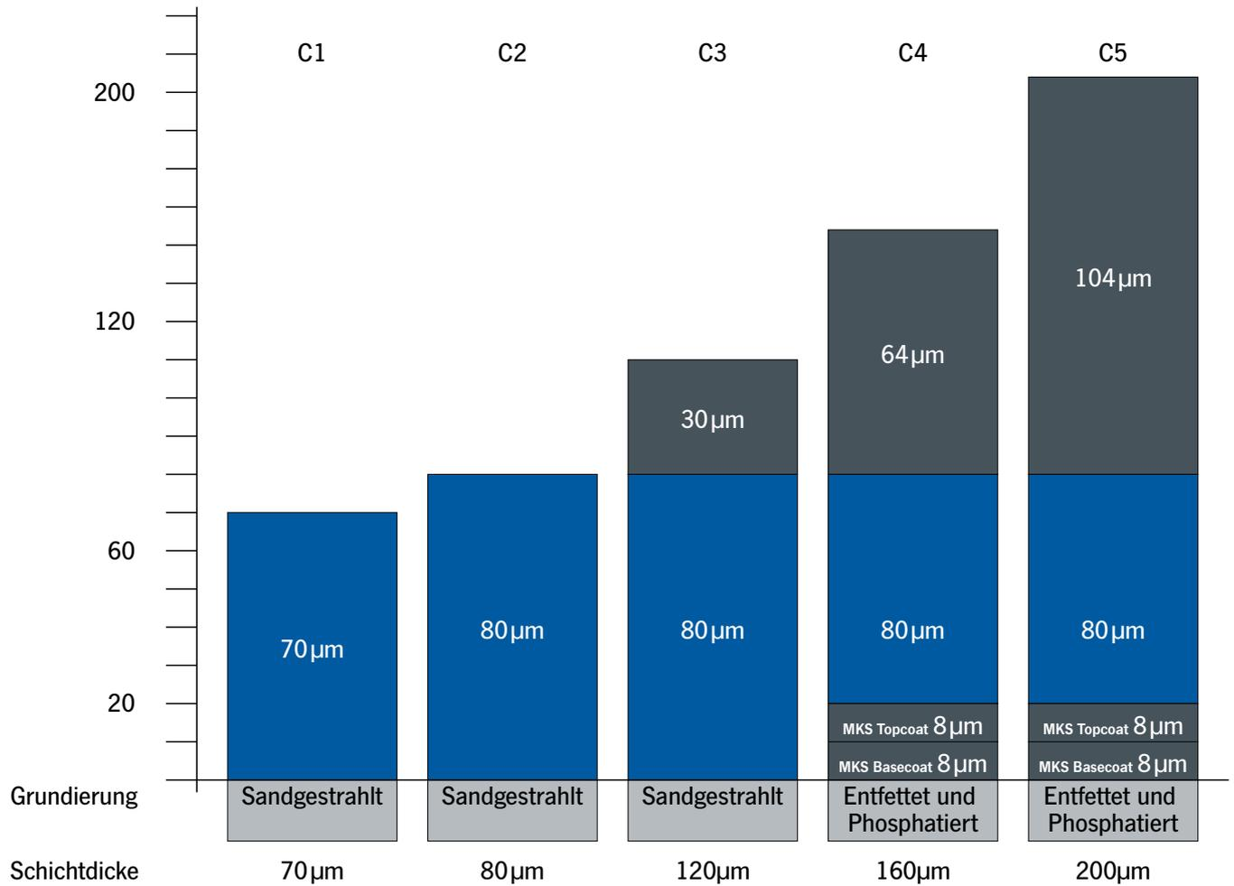
Bis zu C3 decken wir alle Standardlackierungen (Nasslackierung und Pulverbeschichtung) bei unseren Produkten ab. Somit sind auch die Korrosivitäts-Kategorien C1 und C2 abgedeckt.
