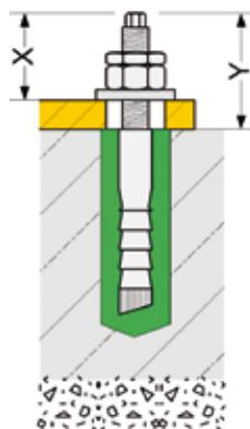
Der kleinstmögliche Überstand des Verbundankers über die Kranfußplatte „X“ bei Verbundanker M12 beträgt ca. 33 mm, bei M16 ca. 37 mm. Dieses Maß kann nur dann erreicht werden, wenn die Betonbodenplatte die oben angeführte Mindeststärke überschreitet. Der maximale Überstand des Verbundankers, gemessen vom Bodenniveau „Y“, beträgt bei der jeweiligen Mindestbodenplattenstärke bei Verbundanker M12 ca. 73 mm und bei M16 ca. 86 mm.
