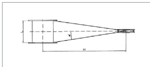
Der Abstand zwischen Steiltrommel und Umlenkrolle sollte so ausgeführt sein, dass ein maximaler Ablenkungswinkel für die verwendete Seilart nicht überschritten wird:
