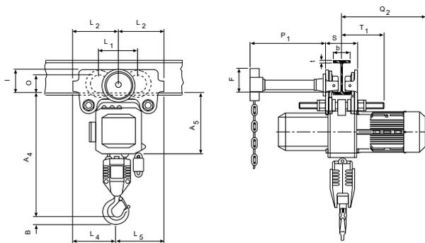
CPE1/CPEF Festverbindung mit Haspelfahrwerk
