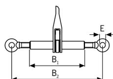
Ratschlastspanner mit Ausdrehsicherung, beidseitig mit Öse, EN 12195-3.
