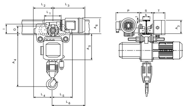
CPE1/CPEF Festverbindung mit Elektrofahrwerk
