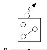
Steigt der Druck auf den eingestellten Wert an, spricht der eingebaute Mikroschalter (Wechselkontakt) an. Bei Absinken des Druckes fällt der Mikroschalter wieder ab.
