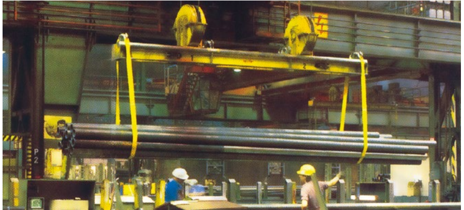
Bild 1-11: Sicheres Anschlagen langer Lasten
