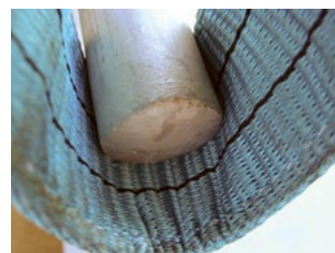
Bild 1-8: Unzulässige Auflage der Last im Hebeband
