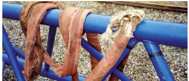
Bild 4-5: Starke Beschädigung der Ummantelung und der Einlage
