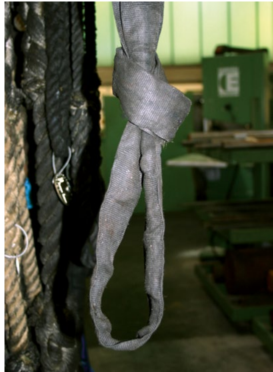
Bild 1-3: Unzulässiger Knoten in einer Rundschlinge
