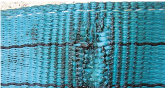
Bild 4-3: Durch Wärmeeinfluss beschädigte Oberfläche
