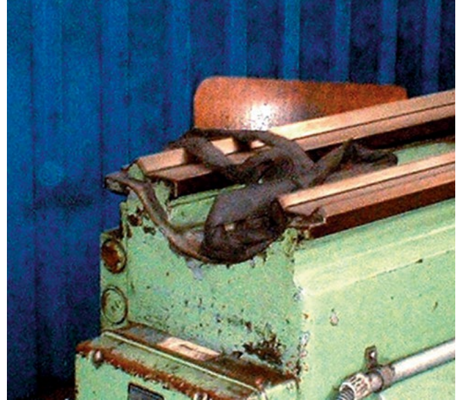
Bild 5-2: Ungünstige Lagerung von Anschlagmitteln, Beispiel 2
