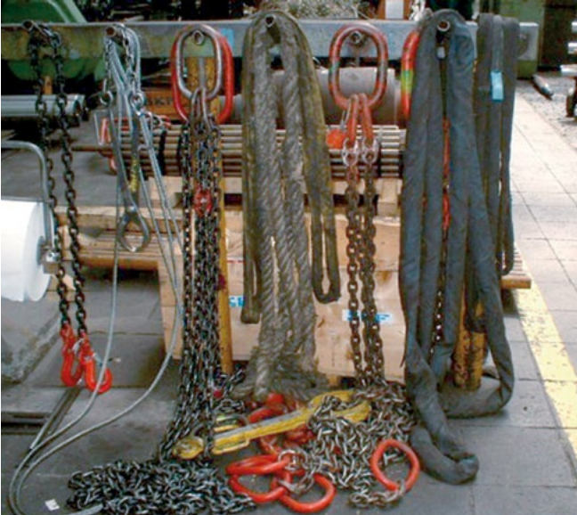
Bild 5-1: Ungünstige Lagerung von Anschlagmitteln, Beispiel 1
